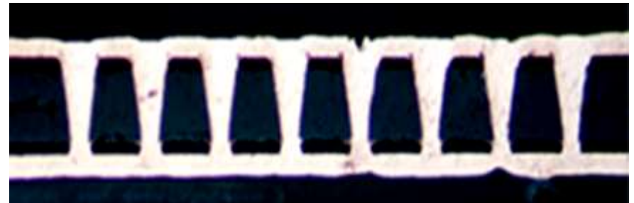
60-25 Hole Ø Top/Bottom - 100µm Glass 15µm ZIF Polymer - 22µm Cu Overburden
